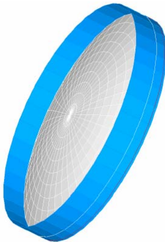
圖 4.13a 在 3D Viewer 中預覽 TUBE 命令的結果。因爲透鏡的規格並未包含開始面與結束面的坐標，開始時我們的猜測值可以略大。下一步我們可以使用 BOUNDS 來修飾物件去掉不想要的部分。
