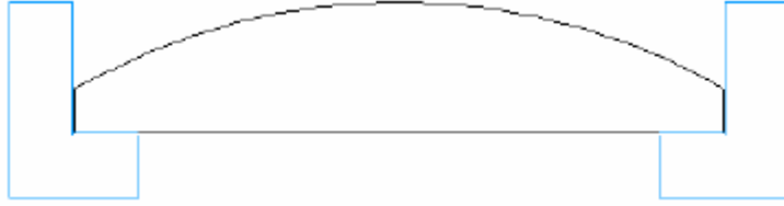
圖 13.13a 一個透鏡固定座被設計來固定一個平凸透鏡 (Plot Viewer)
